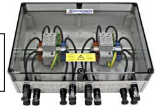
Überspannungsableiter Box mit 2 Photec C1000Vdc für 2 String für 2 MPP-Tracker
